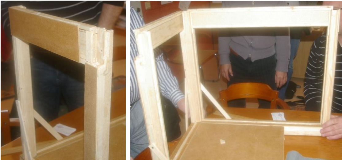
Figur 3. Huvudbärbalkar monterade mellan pelare
